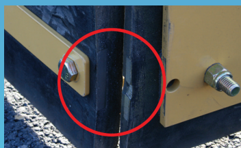
Couteau de "rubber" renforcé par une lame en acier
