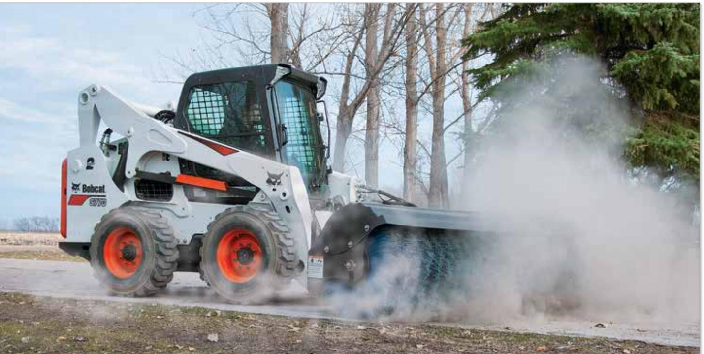
Nettoyez avec votre chargeuse Bobcat®. Utilisez le balai d'angle hydraulique pour balayer les entrées de garages, les trottoirs, les stationnements, les quais de chargement et les entrepôts. Vous pouvez même nettoyer la pelouse, déchaumer, etc. Enfin, ce balai est particulièrement utile pour déneiger rapidement sans endommager la surface des trottoirs.
