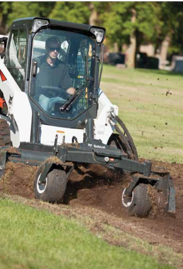
Le préparateur de sol est un accessoire polyvalent et rentable dont les équipes de paysagisme ne peuvent plus se passer. Les dents recouvertes de carbure pulvérisent le sol et les mottes, nivellent la terre et remplissent les trous et les creux. Les roches et autres débris sont alignés sur le côté du chantier, facilitant le nettoyage et l'enlèvement.
