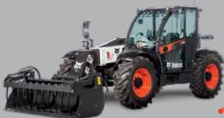
Les porte-outils télescopiques VersaHANDLER® allient les capacités d'une chargeuse à roues, d'un porte-accessoire et d'un chariot élévateur tout terrain. Compatibles avec de nombreux accessoires, ils représentent le summum de la polyvalence sur de nombreux chantiers.
