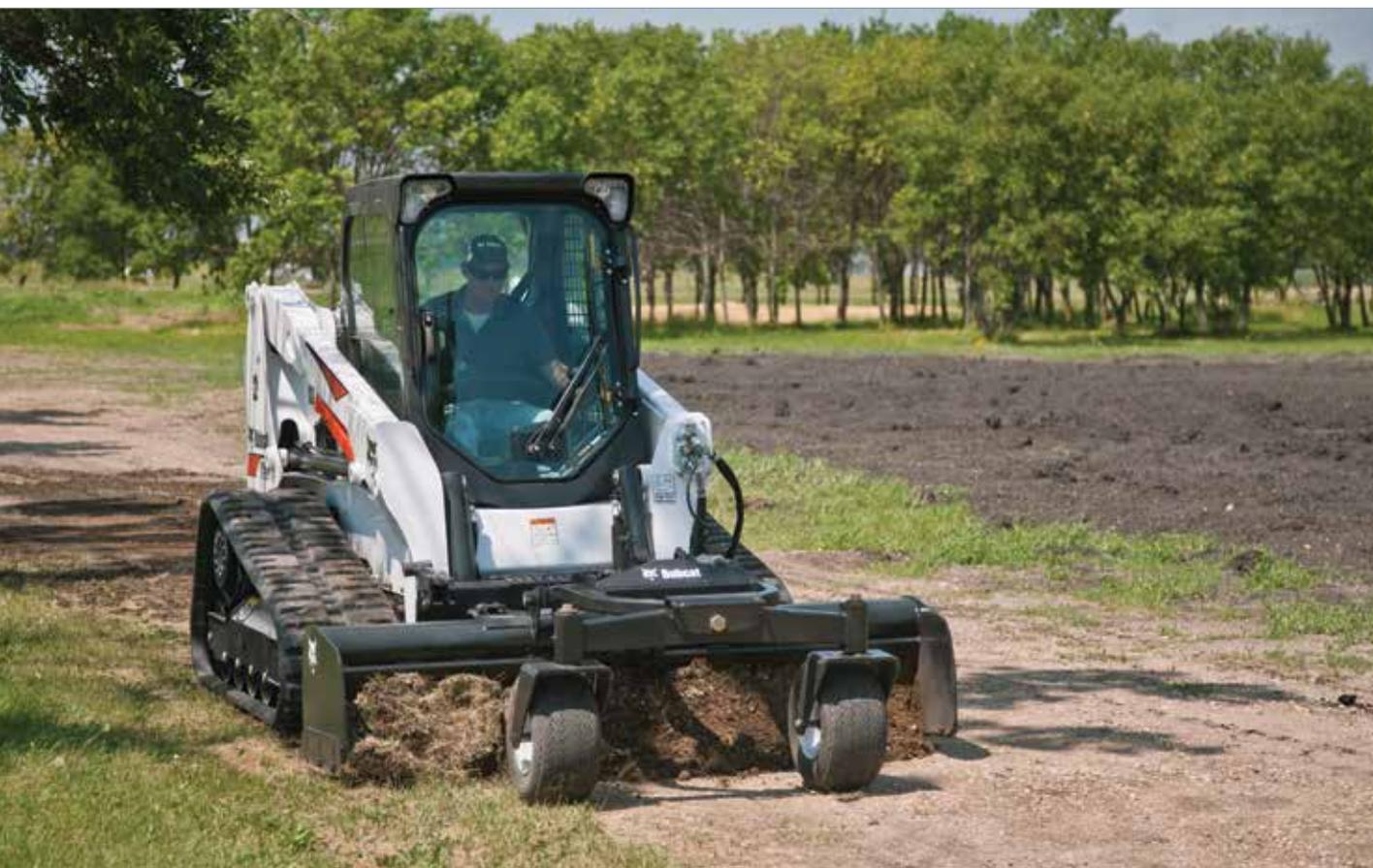
Nivelez rapidement, et réduisez les pertes coûteuses de matériaux grâce à la lame à cloison de Bobcat.
