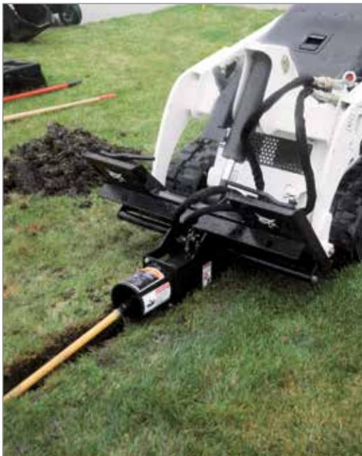
L'accessoire de forage creuse à l'horizontale pour positionner des tuyaux ou des câbles mesurant jusqu'à 4 pouces de diamètre. Après le forage, l'accessoire tire le tuyau ou le câble par le trou. Fixez la tête d'entraînement à l'avant de la chargeuse et positionnez-la au centre, sur le côté droit ou sur le côté gauche. Ainsi, l'accessoire peut être placé tout contre les bâtiments et les obstacles, et exactement là où le forage doit être fait.
