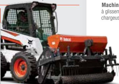
**Machines compatibles :** Chargeuses à direction à glissement, chargeuses compactes à chenilles, chargeuses à direction intégrale, machines utilitaires Toolcat<sup>MC</sup>
