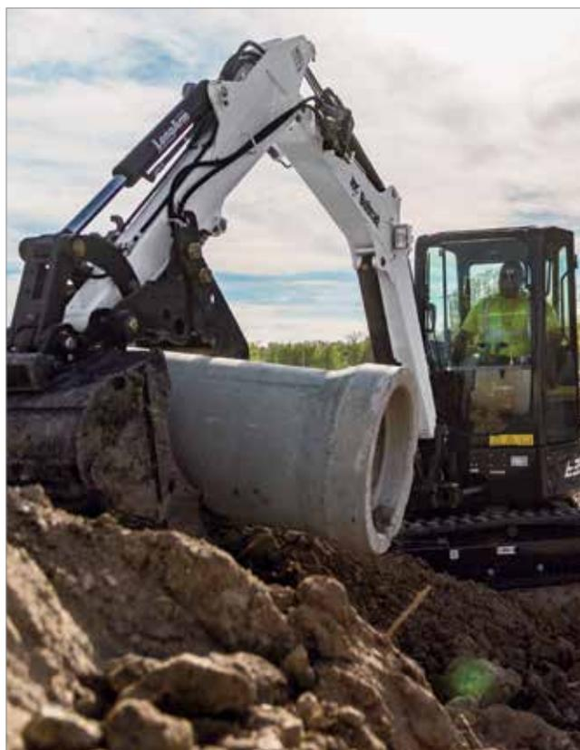
Des outils de travail interchangeables pour agripper et niveler. Choisissez entre le pince de préhension et l'outil de nivellement. Ils peuvent tous les deux s'adapter à différents matériaux ou chantiers en changeant simplement l'emplacement de la goupille.
