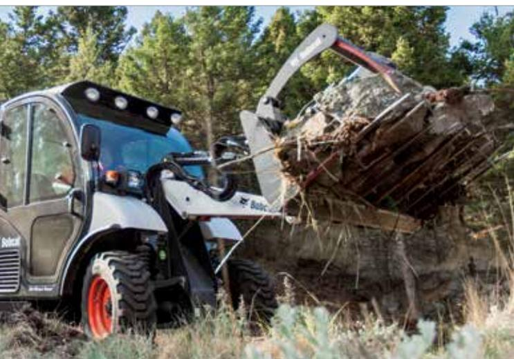
Grâce à la fourche utilitaire de Bobcat®, vous pouvez manipuler des fagots, de la paille, du fumier et autres matériaux difficiles à agripper. Les dents coniques résistantes se remplacent facilement et peuvent gérer efficacement toutes sortes de tâches agricoles. Utilisez le dispositif de fixation des accessoires Bob-Tach® exclusif pour fixer rapidement la fourche utilitaire à votre porte-outil.
