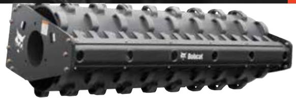
L'action vibratoire du rouleau réaligne et compacte le matériau à partir du fond. Un moteur hydraulique entraîne un poids centrifuge situé sur l'arbre du tambour pour compacter le sol. Cet accessoire agile convient parfaitement à la préparation des sites, aux aménagements paysagers et au pavage.
