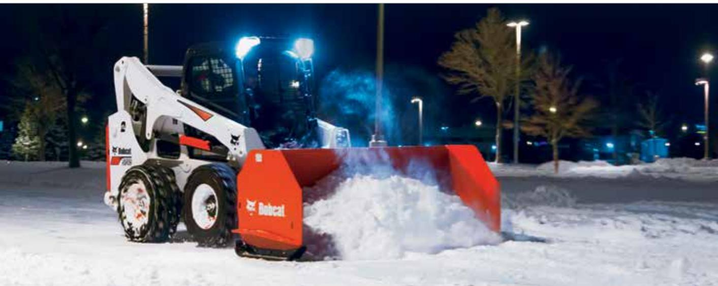
Le fond ouvert et la largeur du chasse-neige offrent une puissance de poussée maximale pour accélérer le déneigement et le rendre plus efficace. Il permet de ramasser et de garder plus de neige, afin de déneiger des zones plus grandes sans avoir à s'arrêter aussi souvent. Parfait pour les stationnements, les entrées de garages et les zones autour des bâtiments.
