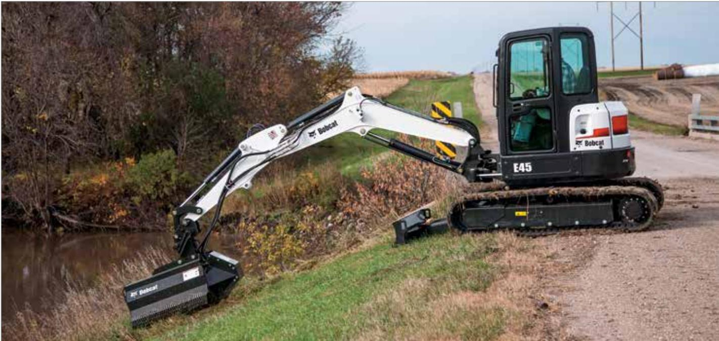
Coupez les broussailles, les taillis, les hautes herbes et même les petits arbustes avec la tondeuse à fléaux Bobcat®. Elle coupe efficacement, grâce à son moteur hydraulique à entraînement direct qui génère un équilibre optimal entre le couple et le régime. Ses fléaux à couteaux triples déchiquettent le bois dur et résineux, les lianes, l'herbe et les broussailles.
