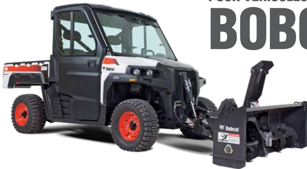
Vous pouvez travailler bien assis aux commandes de votre véhicule utilitaire Bobcat® 3650. Il vous suffit de fixer l'un des nombreux accessoires à prise de mouvement à votre système X-Change<sup>MC</sup> (M.A.X). Un accélérateur indépendant pour le moteur vous permet de contrôler séparément le régime du moteur et la vitesse de déplacement, afin d'obtenir le plus de couple à faible vitesse.
