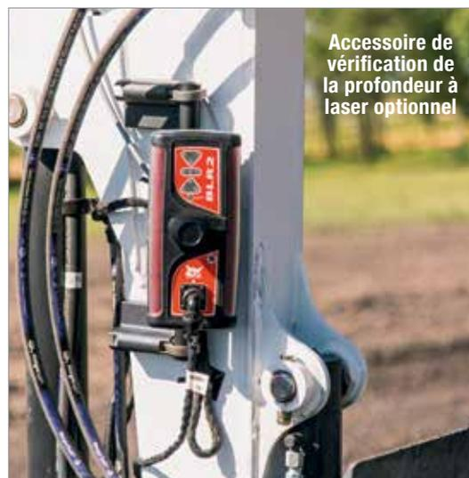
Accessoire de vérification de la profondeur à laser optionnel
